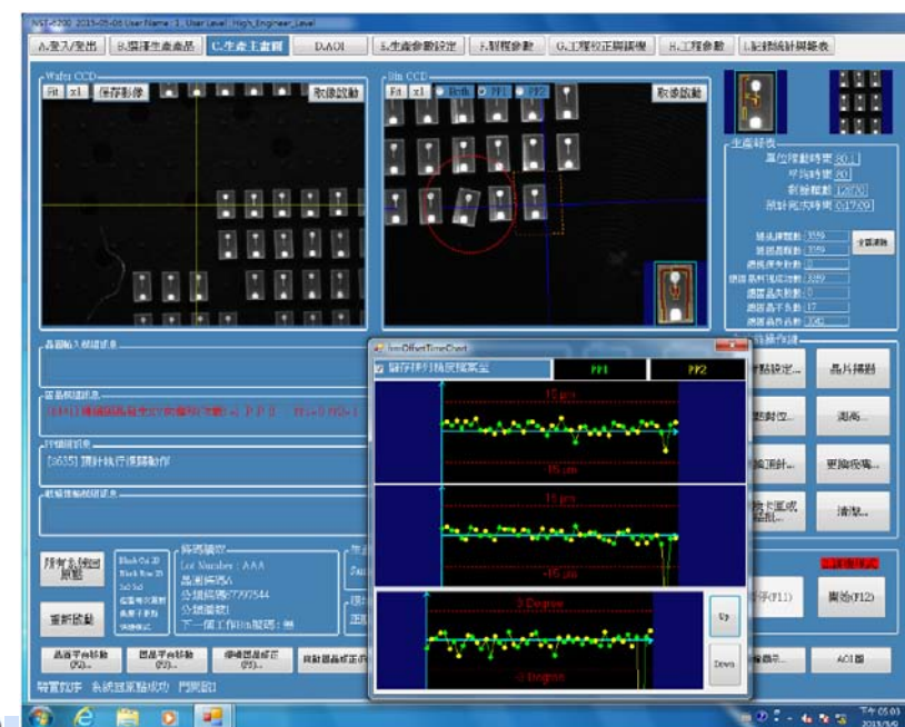
圖3 晶粒排列不良的結果圖
